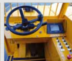
3 Mandos y displays en cabina de conducción
